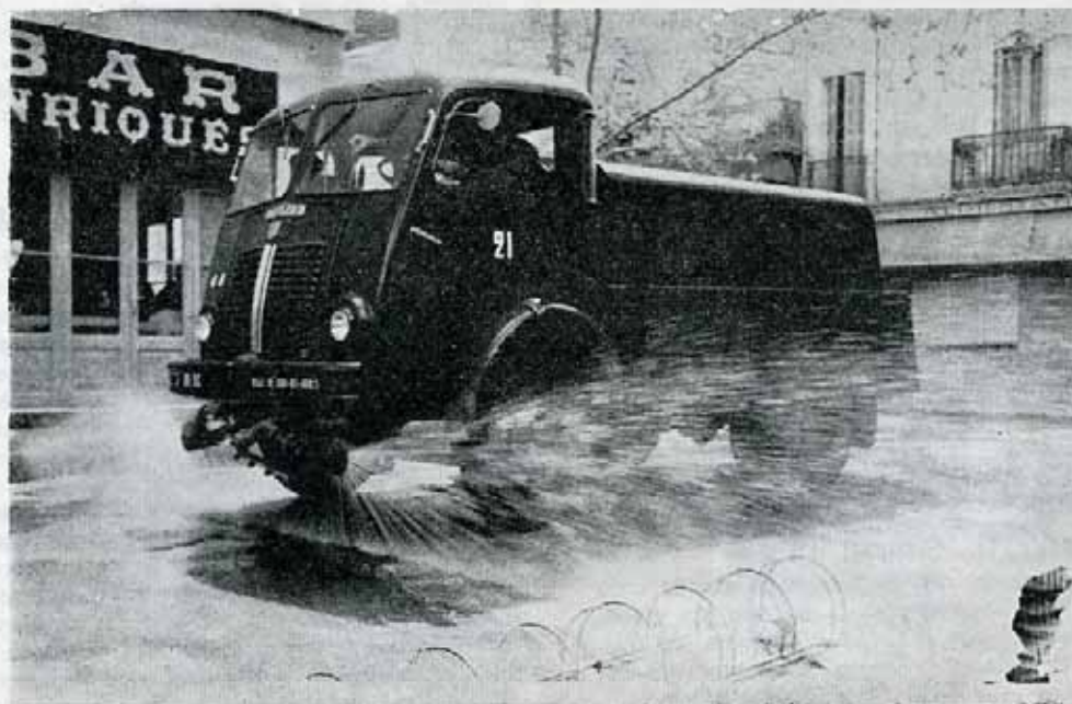
L'arroseuse-balayeuse en action. Eté : arrosage ; Hiver : balayage.
