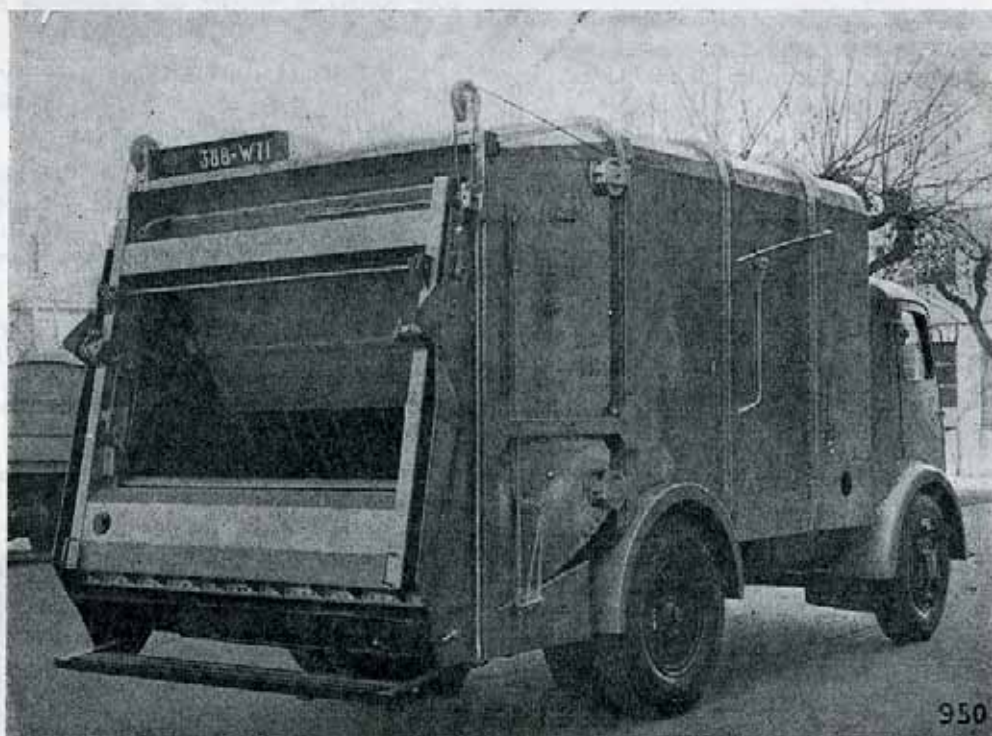
Benne tasseurse Sovel, en tôle d'acier d'une capacité de 10 m 3 , 5.
